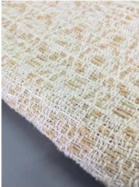
ภาพที่ 12 ผ้าทอที่ใช้เส้นด้ายยืนเป็นเส้นด้ายฝ้าย และเส้นด้ายพุ่งเป็นเส้นใยผสมระหว่างเส้นใยผลตาลสุกและเส้นใยพอลิเอสเตอร์
