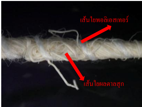
ภาพที่ 11 ภาพกำลังขยายของเส้นด้ายใยผสมจากเส้นใยตาลผสมเส้นใยพอลิเอสเทอร์
